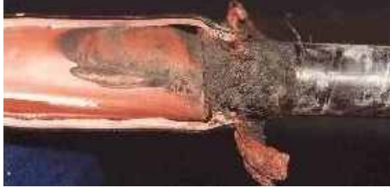
Şekil 2: Uygun seçilmemiş kablonun son durumu
